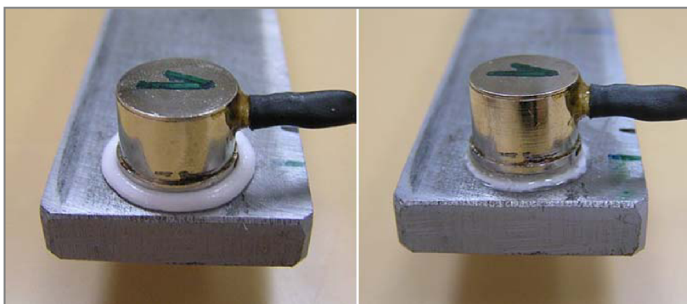
Obr. 5.4: Ukázka nestability vazebného média při zvýšení teploty
