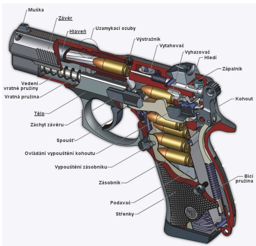
Obrázek 1: Řez zbraně CZ 75
