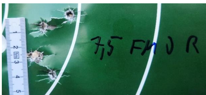
Obrázek 7: Rozptyl továrního náboje FMJ
