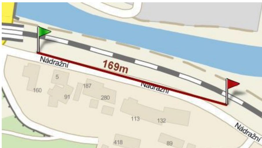
Obrázek 5.4: Maximální vzdálenost mezi vysílačem a přijímače s přímou viditelností
