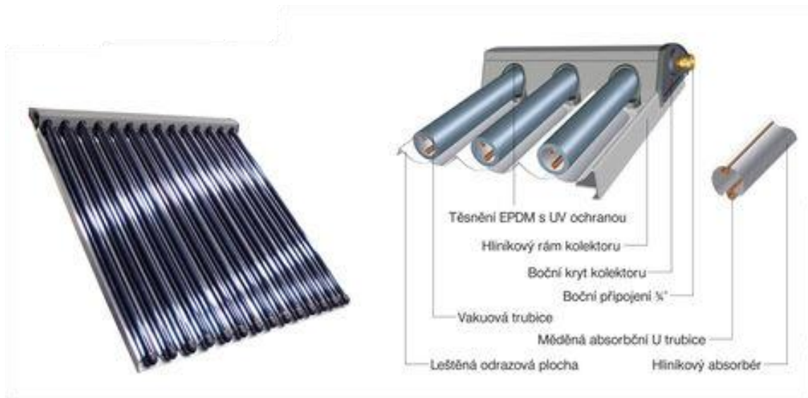
Obr. 4: Trubicový vakuový kolektor [9]
