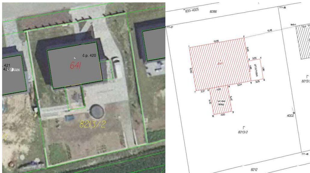
Obr. 13: Zobrazení v katastrální mapě (k.ú. Žarošice) a náčrt ZPMZ 890 ke geometrickému plánu pro vyznačení stavby do mapy katastru nemovitostí z roku 2018.
