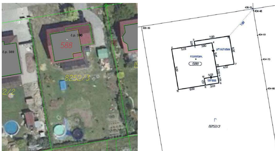
Obr. 19: Zobrazení v katastrální mapě (k.ú. Žarošice) a náčrt ZPMZ 678 ke geometrickému plánu pro vyznačení rozestavěné stavby do mapy katastru nemovitostí z roku 2008.
