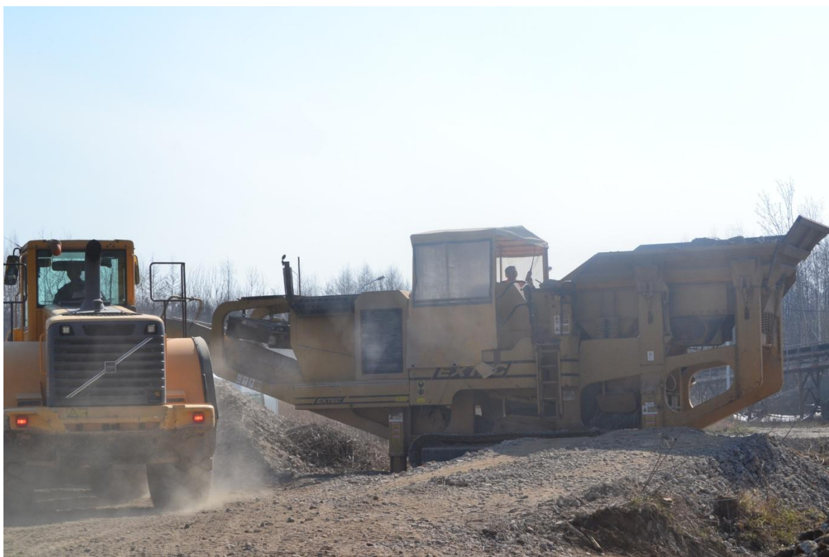
Obr. č. 6 Mobilní drtič EXTEC a kolový nakladač (Tomšíková, 2014)
