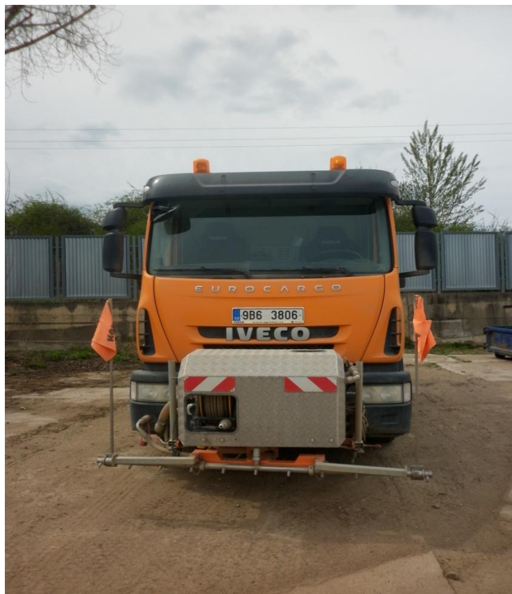
Obr. č. 10 „Čistící vůz“ na skrápění a čištění vozovky v oblasti střediska (Tomšíková, 2015)
