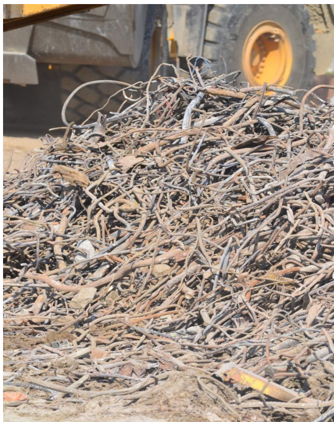
Obr. č. 2 Vyseparovaný kov z magnetického odlučovače kovů (Tomšíková, 2014)
