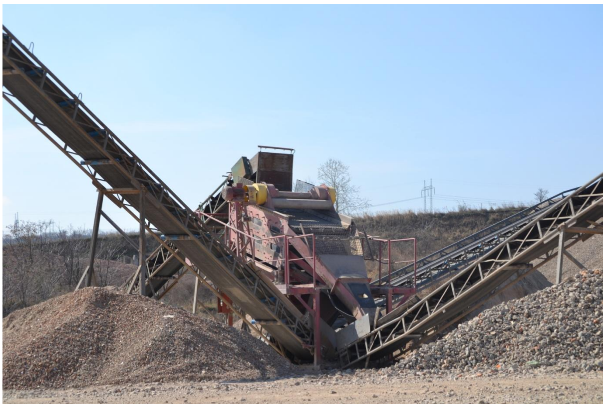
Obr. č. 5 Třífrakční třídicí stacionární linka s dopravníky (Tomšíková, 2014)
