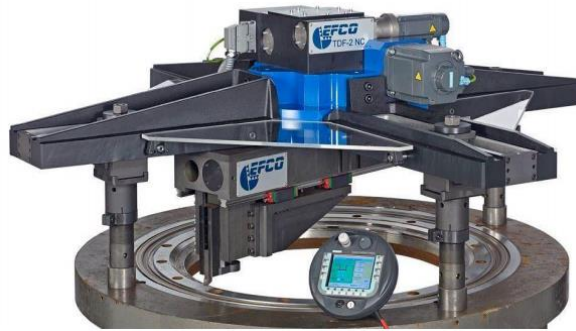
Obr. 2) Soustruh TDF-2 NC firmy EFCO [31]
