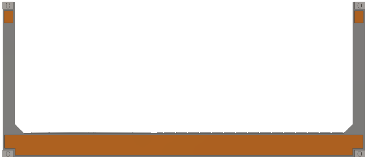
Obr. 34) Označení oblastí umístění šroubů [vlastní zpracování]
