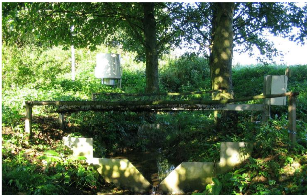
Obr. č. 15: Měrný profil P6 - měrný přepad s ultrazvukovou sondou a dataloggerem vpředu, vzorkovač ISCO se solárním panelem vlevo vzadu
