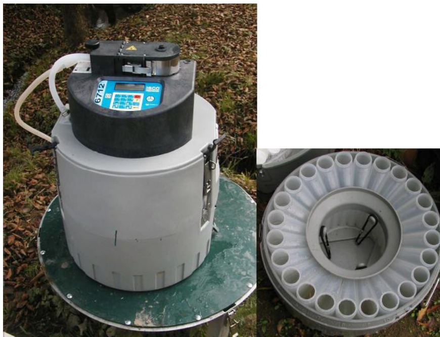
Obr. č. 14: Vzorkovač ISCO vlevo, sada 24 kusů vzorkovnic ze spodní části vzorkovače vpravo
