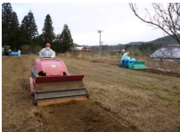
Obr. 3.9 Použití traktoru s kladívkovým mulčovačem (zdroj: report (Ito, 2012))
