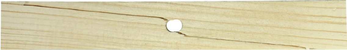
Obrázek 71 - typické porušení vzorku s odklonem vláken
