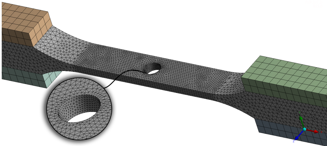
Obrázek 20 - Příklad síťování modelu
