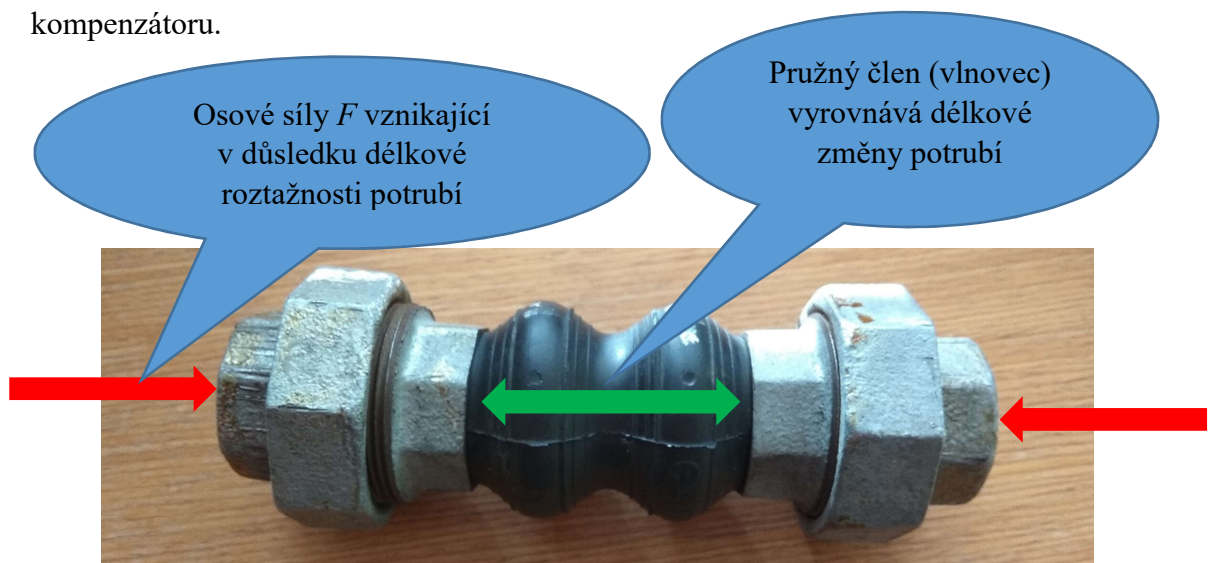
Obr. 7.6: Osový kompenzátor
