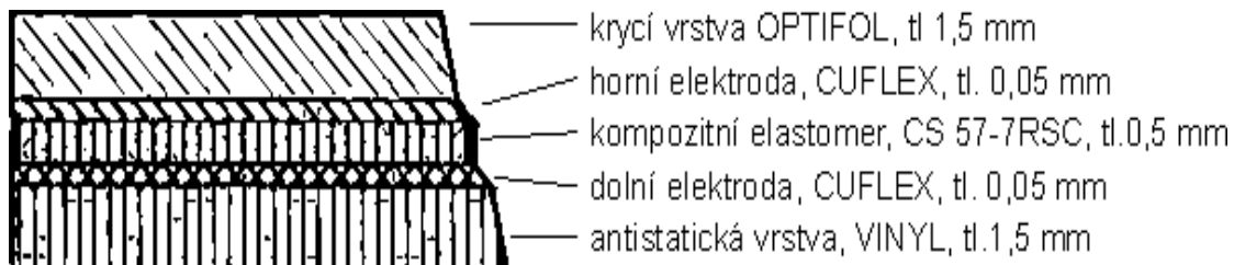
Obr.2 Schéma senzoru s použitím vodivého elastomeru. Převzato z [5].
