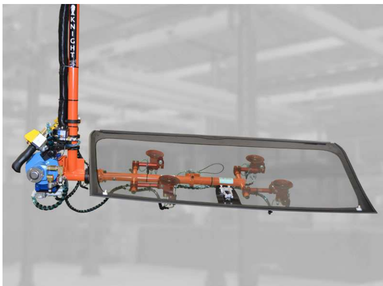
Obr. 9.: Podtlakový koncový efektor [7]
