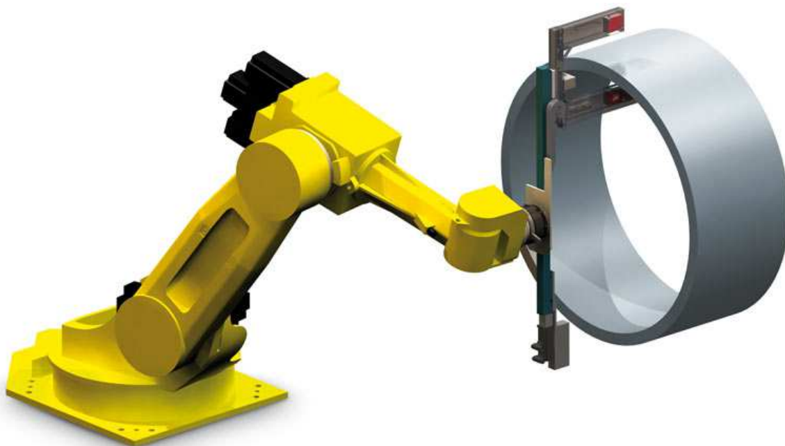
Obr. 11.: Měřicí koncový efektor [9]
