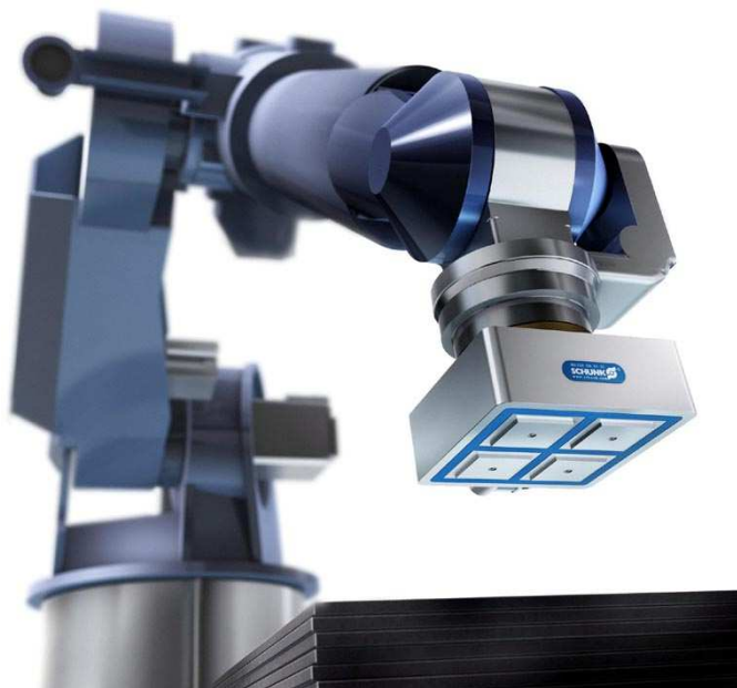
Obr. 8.: Magnetický koncový efektor [6]
