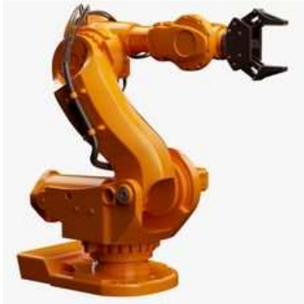
Obr. 7.: Mechanický koncový efektor [5]
