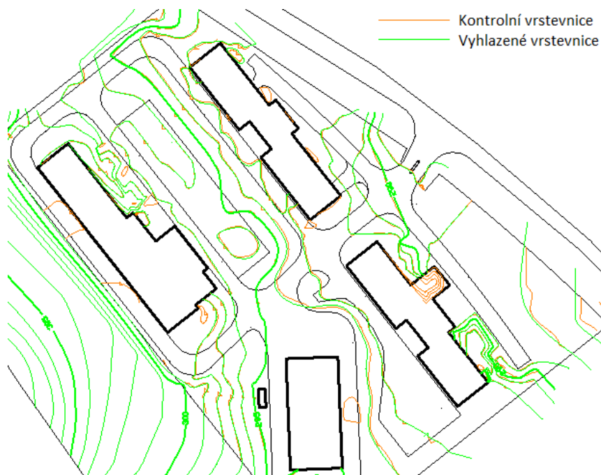
Obrázek 47 – Porovnání vrstevnic z terestrického měření a mračna bodů
