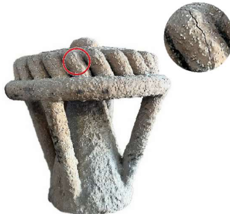
Obr. 6 Praskliny na skořepině oběžného kola [11].
