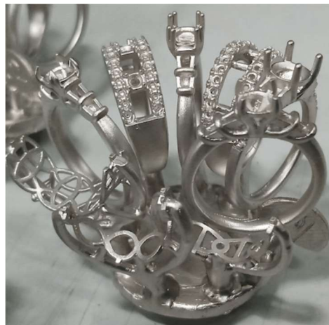
Obr. 9 Surový odlitek šperků zhotovený odstředivým litím [19].
