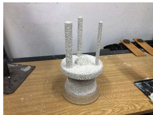
Obr. 18 Model po nanesení sek. obalu.
