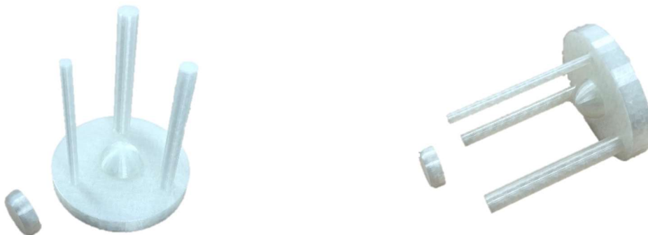
Obr. 15 Zhotovený model odlitku.
