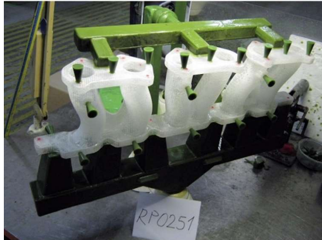
Obr. 5 Model zhotovený metodou SLA připravený na obalování [10].
