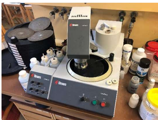
Obr. 26 Broušení vzorků na brusce Struers LaboPol-5.
