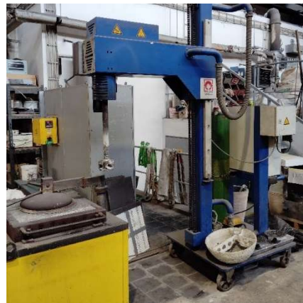
Obr. 20 Rotorové odplyňovací zařízení.
