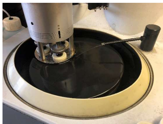
Obr. 26 Broušení vzorků na brusce Struers LaboPol-5.
