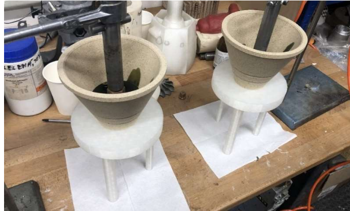
Obr. 16 Lepení nálevky na model.
