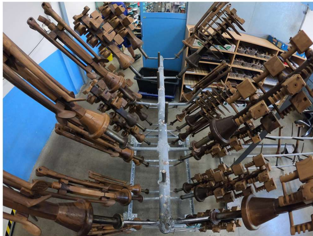
Obr. 4 Modely sestavené do stromečků [8].
