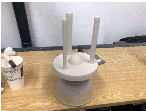
Obr. 17 Model po nanesení prim. obalu.
