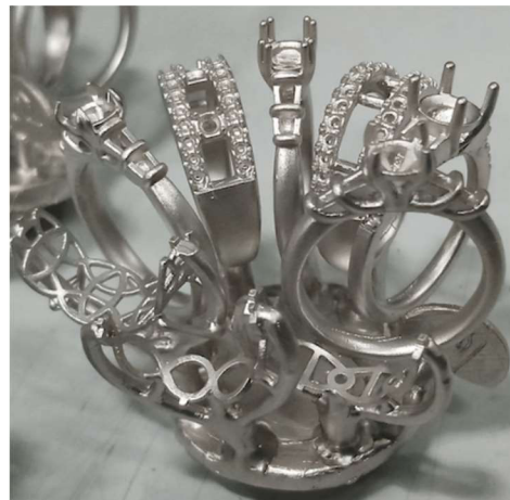
Obr. 9 Surový odlitek šperků zhotovený odstředivým litím [19].
