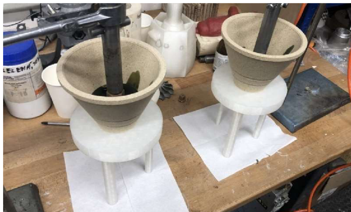
Obr. 16 Lepení nálevky na model.
