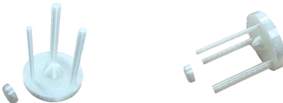
Obr. 15 Zhotovený model odlitku.
