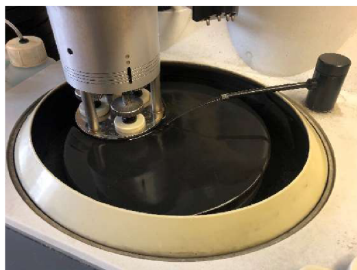
Obr. 26 Broušení vzorků na brusce Struers LaboPol-5.
