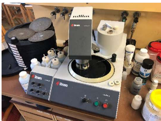
Obr. 26 Broušení vzorků na brusce Struers LaboPol-5.
