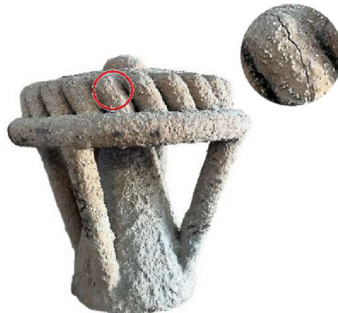
Obr. 6 Praskliny na skořepině oběžného kola [11].
