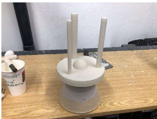
Obr. 17 Model po nanesení prim. obalu.
