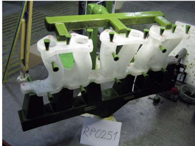
Obr. 5 Model zhotovený metodou SLA připravený na obalování [10].
