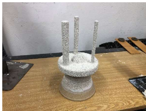
Obr. 18 Model po nanesení sek. obalu.
