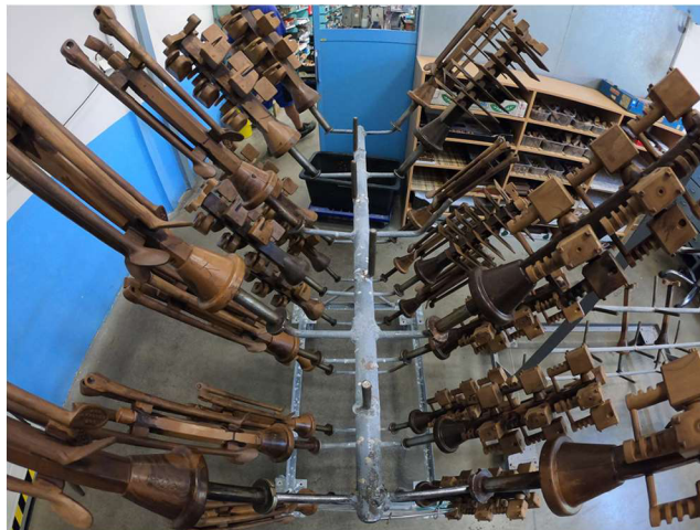
Obr. 4 Modely sestavené do stromečků [8].
