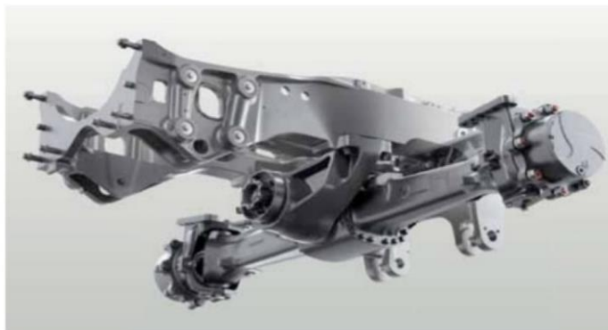
Obrázek 15 Polorámová konstrukce podvozku (www.agroportal24h.cz, 2020)
