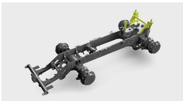
Obrázek 16 Rámová konstrukce podvozku (Slezskastrojni.cz 2020)
