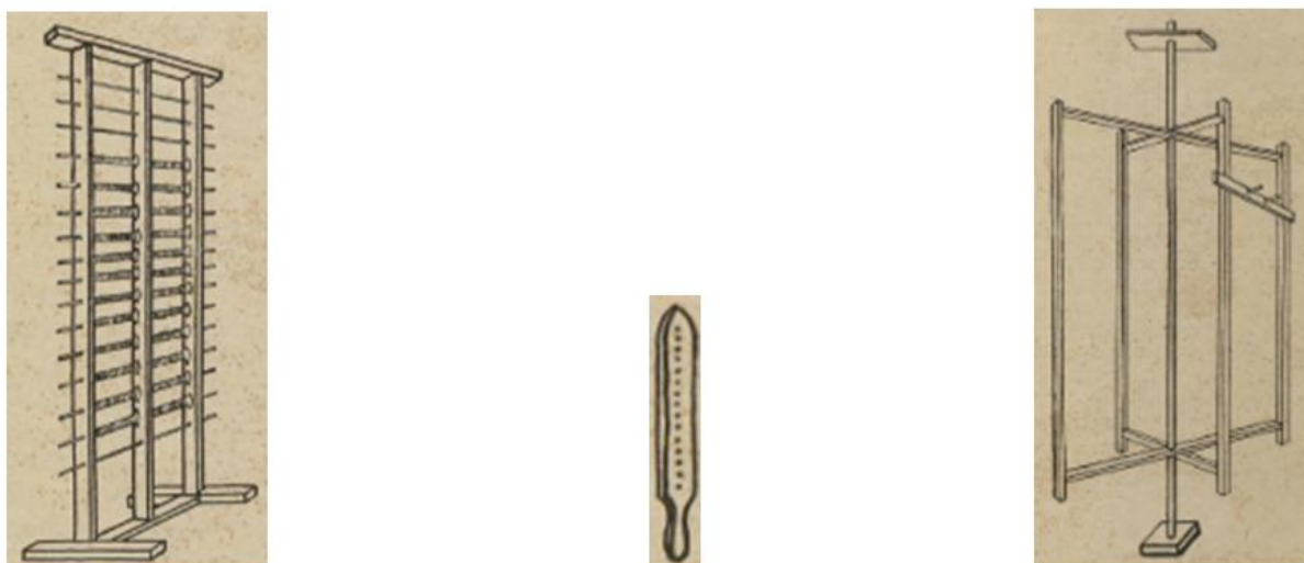
Obr. 6 Zleva: cívčnice, snovací deska, snovadlo 128
