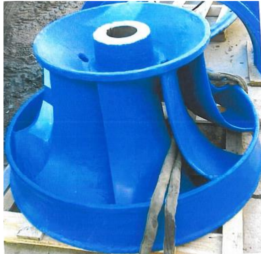
Obr. 4.10 Foto repasované Francisovy turbíny [vlastní zdroj]
