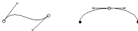
Obrázok 3.1: Na ľavej strane ukážka segmentu splajnu a jeho dotyčníc. Na pravej strane ukážka nadväzovania segmentov
