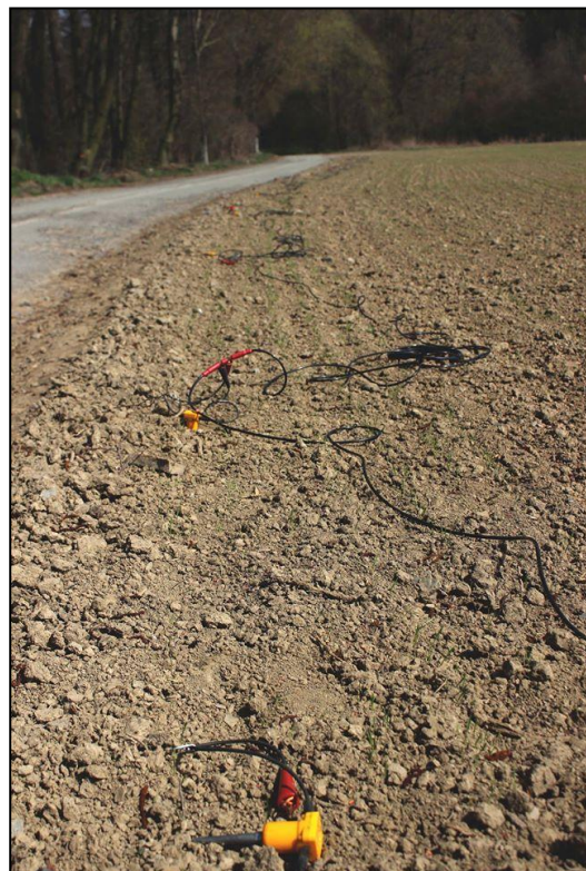
Obr. 14 Ukázka zapojení geofonů na lokalitě Šternberk – údolí Aleš (foto Zuzana Nováková).
