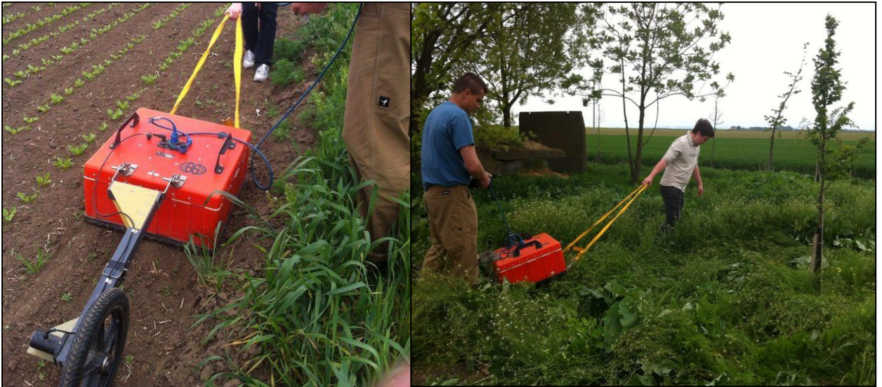
Obr. 19 Ukázka měření pomocí georadaru GSSI SIR 3000 (Geophysical Survey System, Inc., USA), lokalita Kralice (foto Zuzana Nováková).
