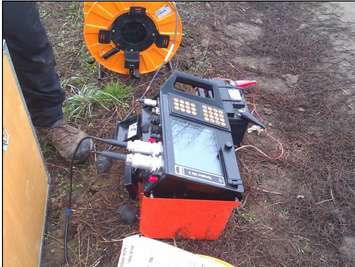
Obr. 13 Ukázka zapojení seismografu ABEM Terraloc Mk8, lokalita Kralice (foto Zuzana Nováková)
