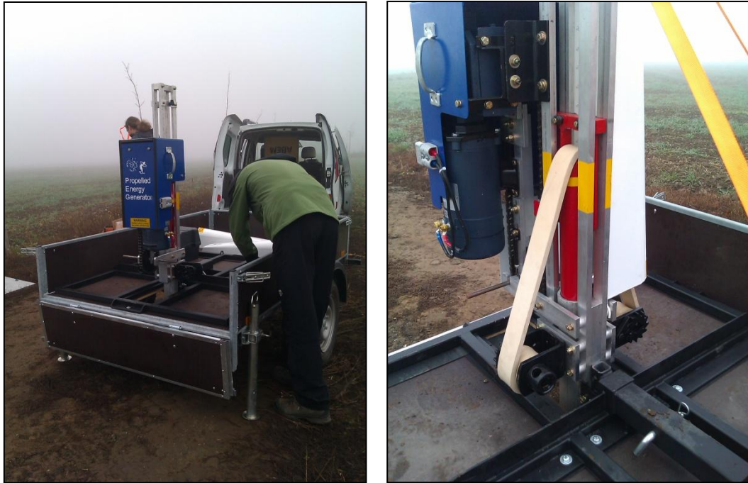
Obr. 15 Zdroj seismických vln - 40 kg kladivo urychlené elastomerovými pásy (Propelled Energy Generator, PEG-40, RT-Clark, USA), lokalita Kralice (foto Zuzana Nováková).
