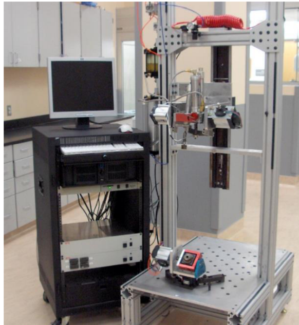
Obr. 1–9 Simulátor kolena pro děti s mozkovou obrnou [25].
