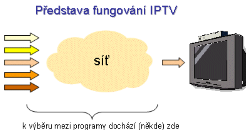
Obrázek 13 - princip přenosu kanálů u IPTV (Peterka, 2006)
