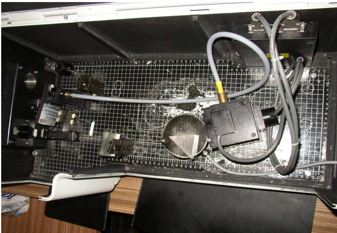
Obr. 78: Optická lavice uvnitř spektrometru PerkinElmer \lambda 950 používaný v Meoptě-optika, s.r.o.
