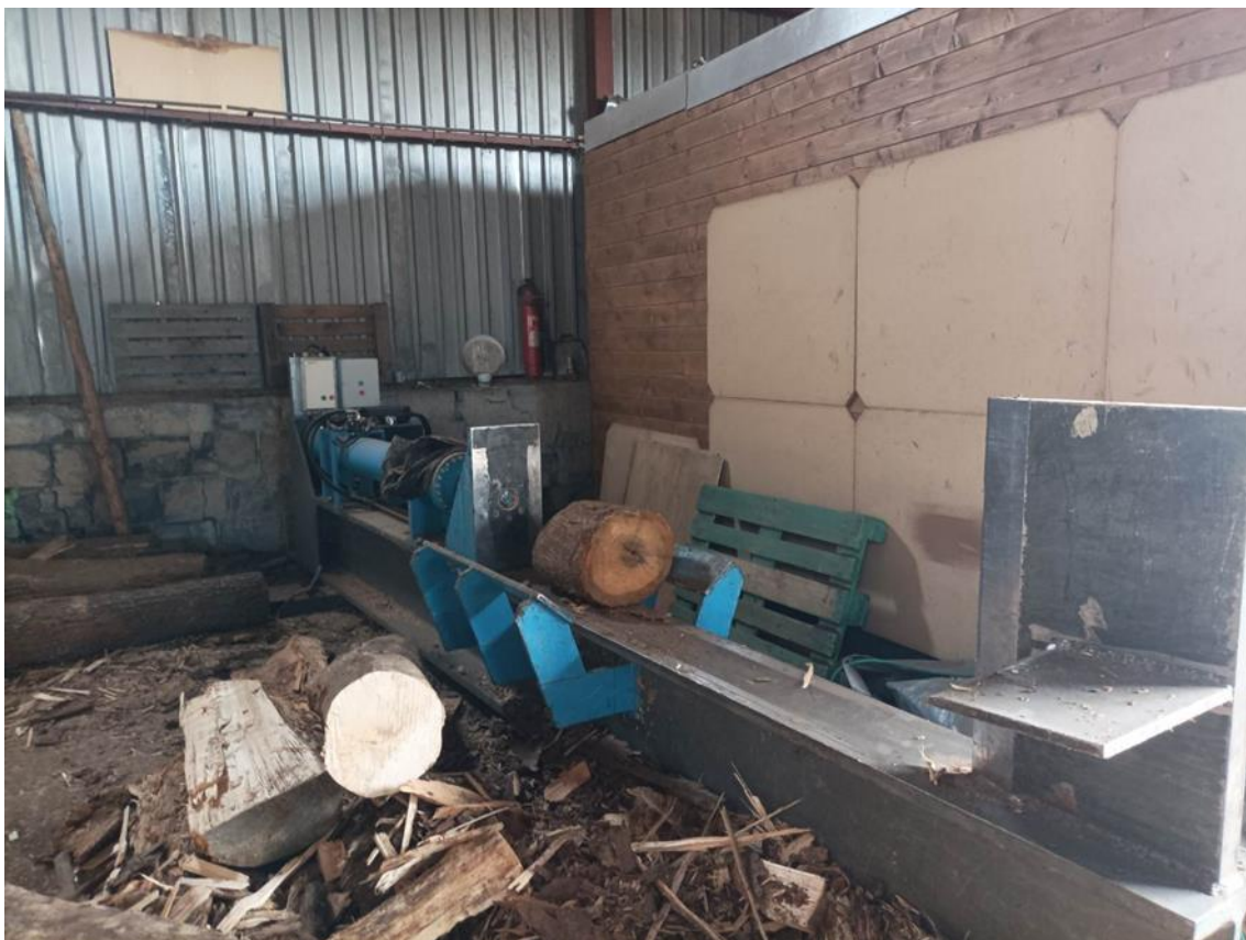
Obrázek 24 – Štípačka na sortimenty s velkou tloušťkou, které se nevejdou do automatu (vlastní zpracování)
