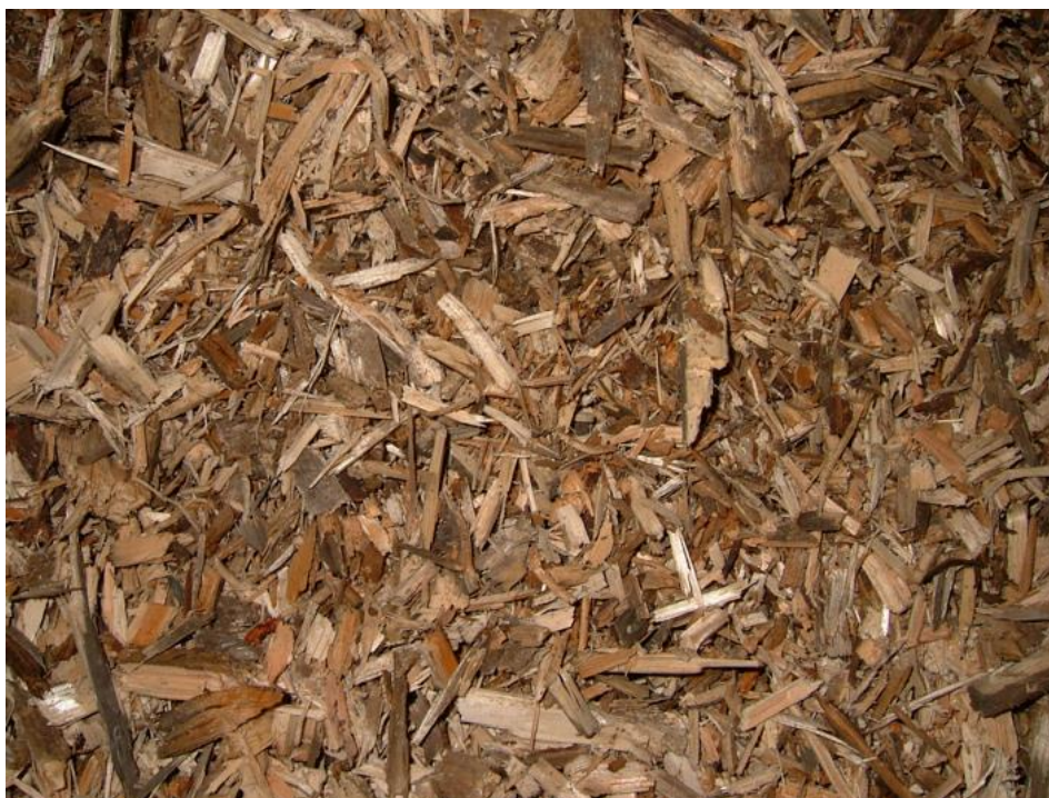
Obrázek 7 - Dřevní štěpka vyrobená kladivovým štěpkovačem (Stupavský, Holý, 2010)
