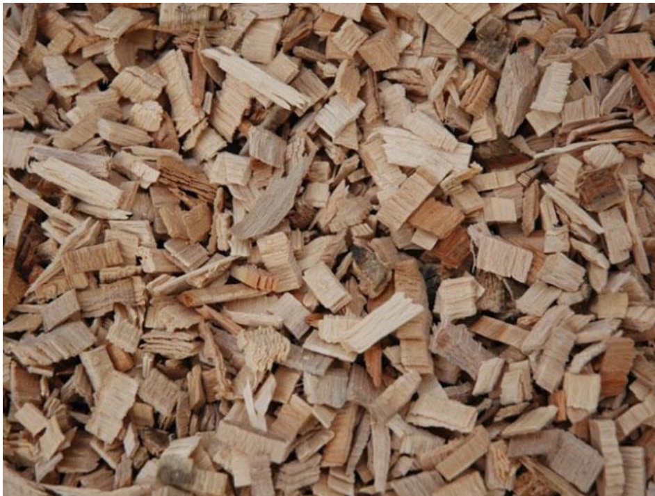
Obrázek 6 - Dřevní štěpka vyrobená nožovým štěpkovačem (Stupavský, Holý, 2010)
