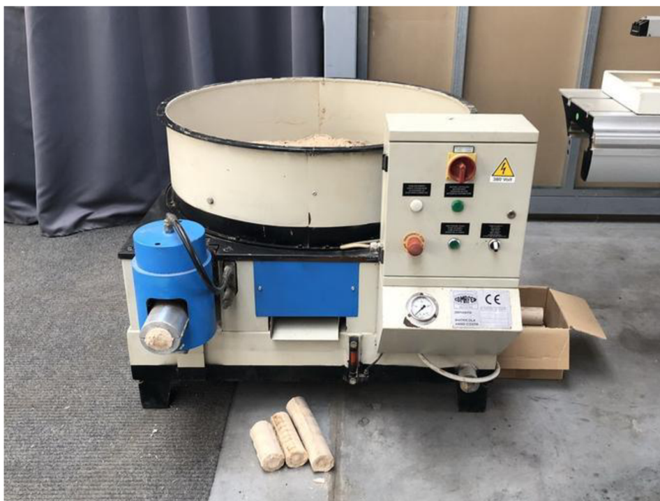
Obrázek 17 - Malý briketovací lis COMAFER DINAMIC 85N (drevoobrabeci-stroje-carbe.cz, 2011)
