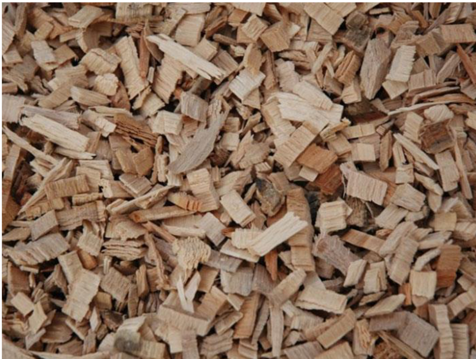
Obrázek 6 - Dřevní štěpka vyrobená nožovým štěpkovačem (Stupavský, Holý, 2010)
