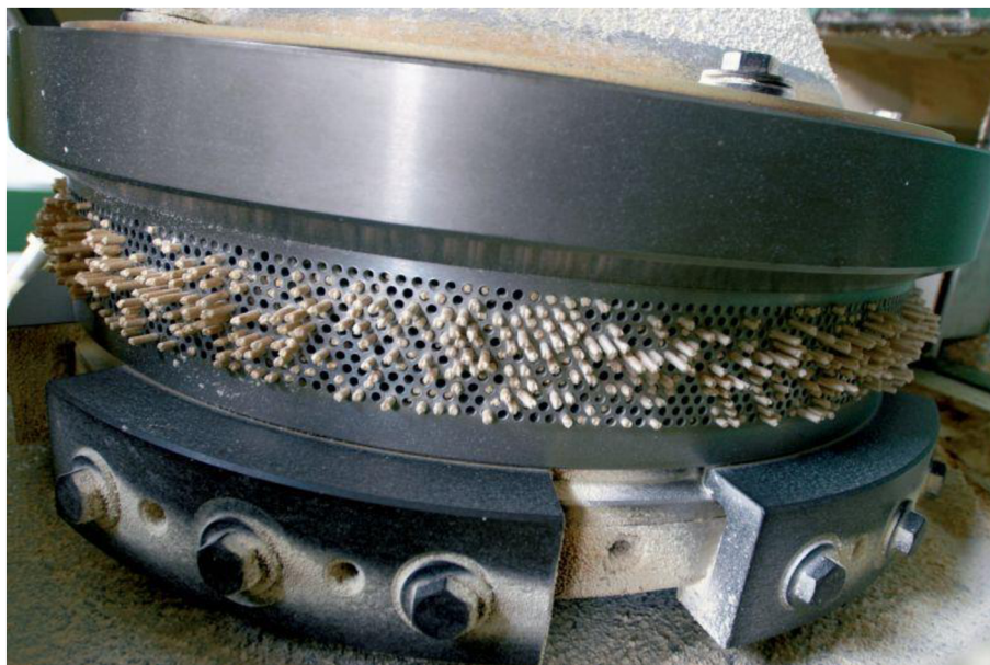
Obrázek 14 - Výroba pelet pomocí paletovacího lisu (ceska-peleta.cz)
