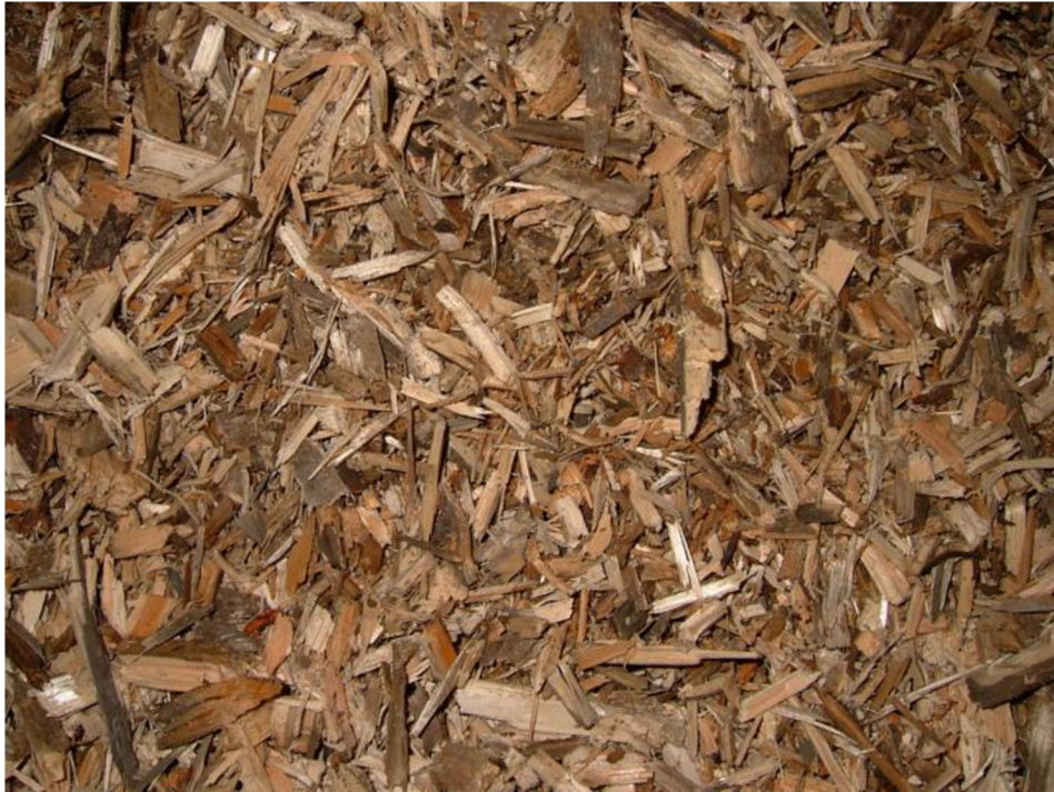
Obrázek 7 - Dřevní štěpka vyrobená kladivovým štěpkovačem (Stupavský, Holý, 2010)
