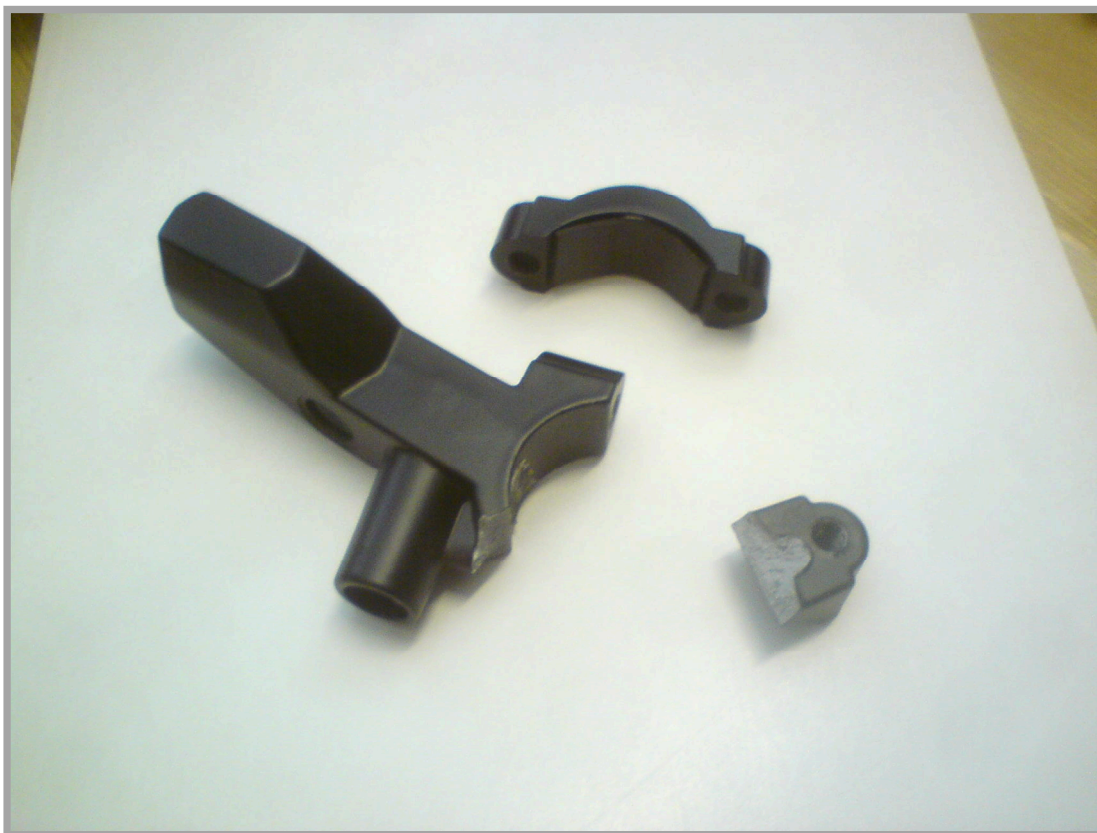
Obr. 3-1 prasklá původní upínka
