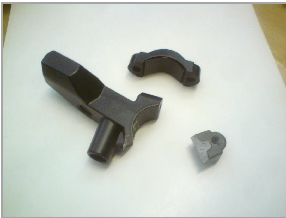
Obr. 3-1 prasklá původní upínka
