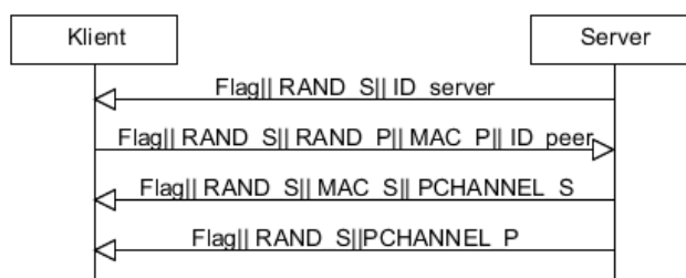
Obr. 3.4 Autentizace využívající EAP PSK
