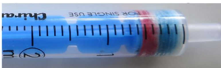
Obrázek 35: Stříkačka s prstencovým uspořádáním po reakci s nikelnatými a železitými ionty.
