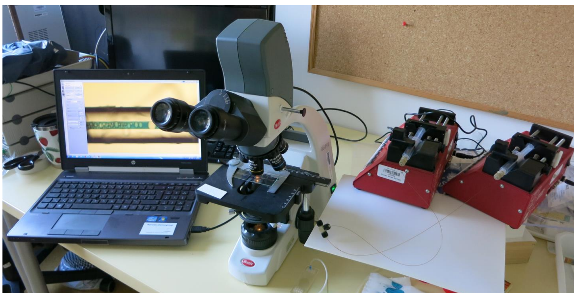
Obrázek 19: Sestava pro generování segmentovaného toku v kapilárách stříkačkovými pumpami
