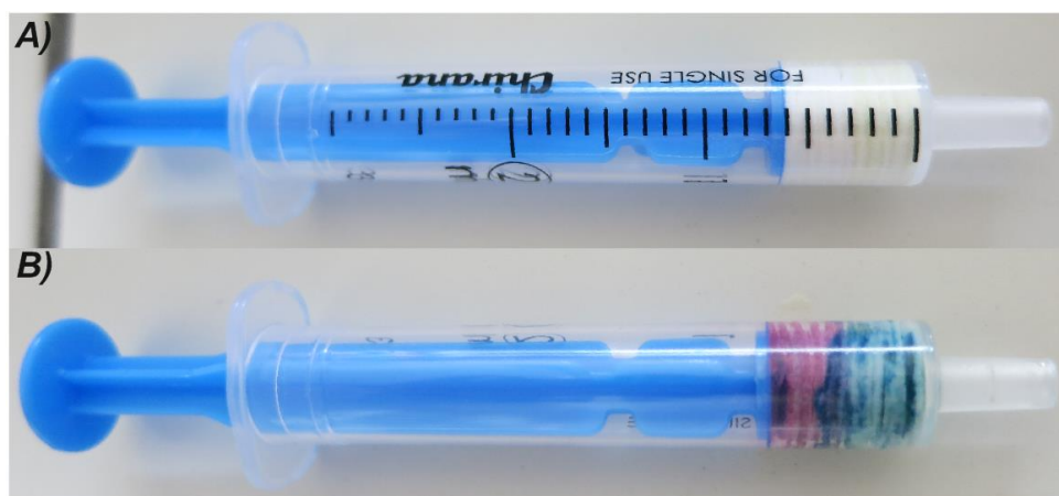
Obrázek 26: Stříkačky pro detekci nikelnatých a železitých iontů. A) Stříkačka připravená k použití, B) Stříkačka po reakci s \text{Ni}^{2+} a \text{Fe}^{3+} ionty, došlo ke smíchání reakčních zón.
