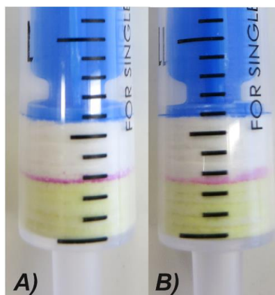
Obrázek 32: Stříkačky pro detekci nikelnatých a železitých iontů. A) Podložka s nezažehlenou oddělovací voskovou vrstvou, B) Podložka se zažehlenou voskovou vrstvou
