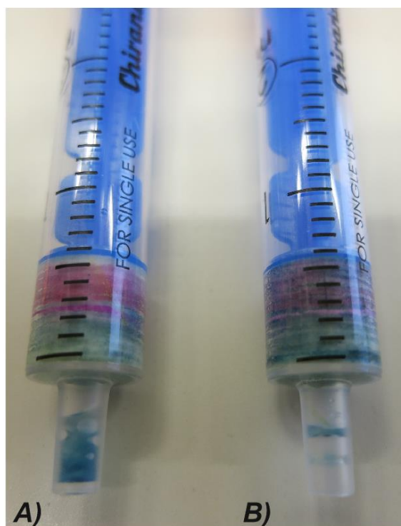
Obrázek 33: Stříkačky po reakci s \text{Ni}^{2+} a \text{Fe}^{3+} ionty, A) Podložka s nezažehlenou oddělovací voskovou vrstvou, B) Podložka se zažehlenou voskovou vrstvou
