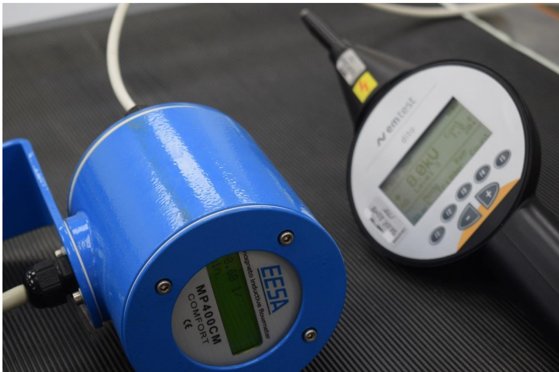
Obr. 16 Průtokoměr ESSA se simulátorem ESD od EM Test a AD hrotem
