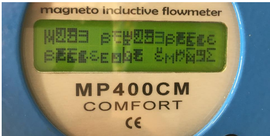
Obr. 20 Průtokoměr po zkoušce ESD, CD, napět'ová úroveň -4 kV
