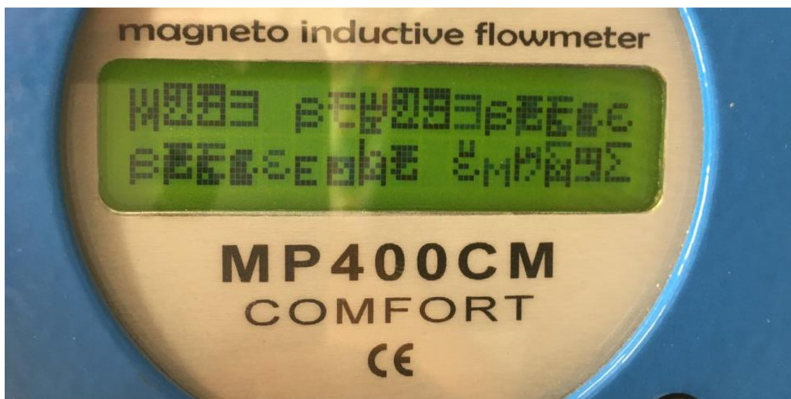
Obr. 20 Průtokoměr po zkoušce ESD, CD, napěťová úroveň -4 kV
