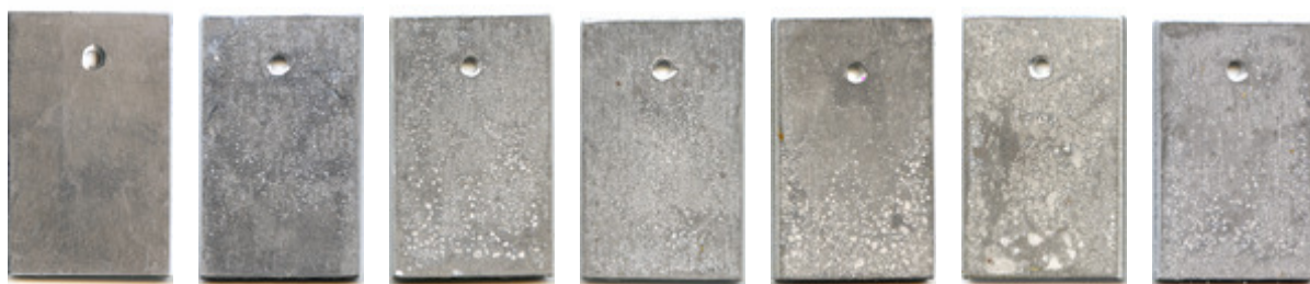
Obr. 4.5.1.2-1 Změna vzhledu povrchu hliníkových vzorků (pasivovaných v přípravku Pragokor BP) v průběhu laboratorní urychlené zkoušky (0, 1, 2, 5, 13, 20 a 30 dní)
