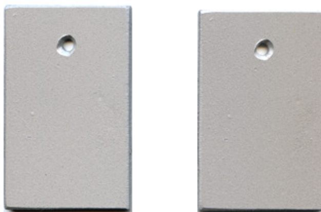
Obr. 4.5.1.2-9 Žádná změna vzhledu povrchu hliníkového zkušební vzorku (pasivovaného v přípravku Pragokor BP, utěsněného v přípravku Pragokor Seal Al a opatřeného zinkovým povlakem) před a po laboratorní urychlené zkoušce (30 dní)
