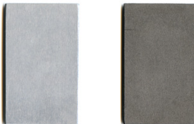
Obr. 4.2.2.2-1 Hliníkový a ocelový vzorek pasivovaný v přípravku Pragokor BP a následně utěsněný v Prgokor Seal Al
