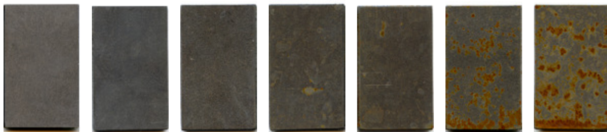
Obr. 4.5.2.2-10 Změna vzhledu povrchu ocelových zkušebních vzorků (pasivovaných v Pragokor BP) v průběhu atmosférické zkoušky (0, 1, 2, 5, 13, 20 a 30 dní)
