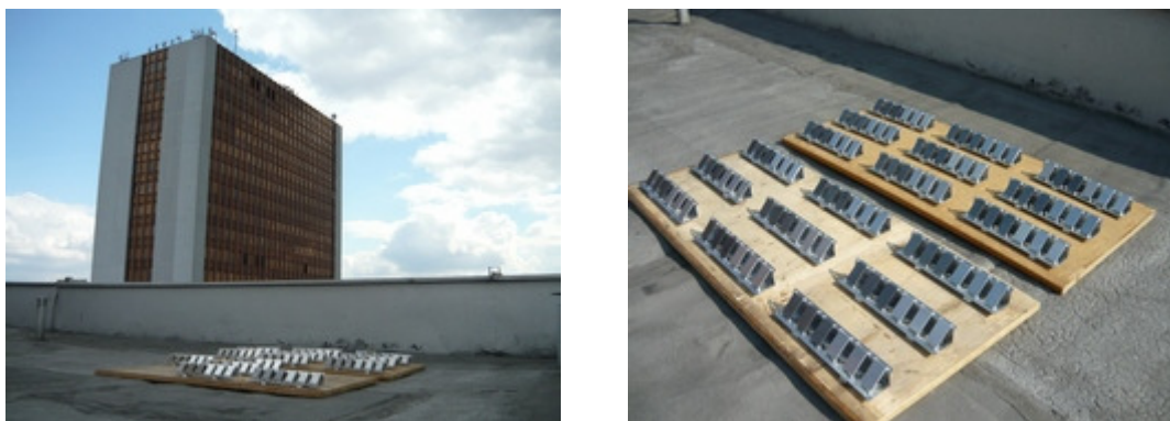
Obr. 4.4.2-2 Vystavení vzorků na střeše jedné z budov Fakulty strojního inženýrství Vysokého učení technického v Brně
