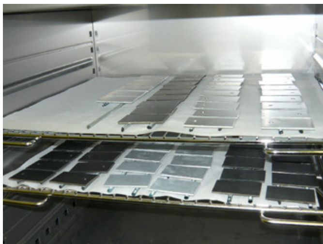
Obr. 4.2.2.2-1 Sušení vzorků za teploty 80°C po jejich utěsnění v přípravku Pragokor Seal Al
