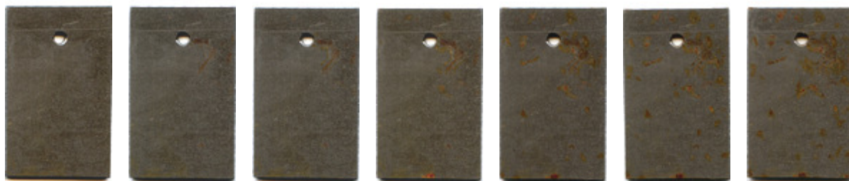
Obr. 4.5.2.2-5 Změna vzhledu povrchu ocelového zkušební vzorku (pasivovaného v Pragokor BP, utěsněného v Pragokor Seal Al a povlakovaného konzervačním voskem) v průběhu laboratorní urychlené zkoušky (0, 1, 2, 5, 13, 20 a 30 dní)
