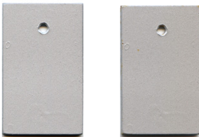
Obr. 4.5.2.2-7 Žádná změna vzhledu ocelového zkušební vzorku (pasivovaného v přípravku Pragokor BP , utěsněného v přípravku Pragokor Seal Al a opatřeného zinkovým povlakem) před a po laboratorní urychlené zkoušce (30 dní)
