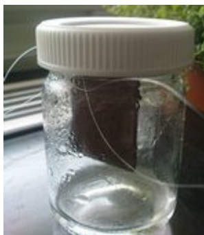
Obr. 4.4.1-2 Vzorek připravený pro urychlenou atmosférickou zkoušku
