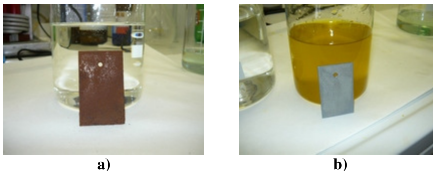
Obr. 4.5.2.3-1 Ocelový vzorek a) před a b) po odstranění korozních produktů
