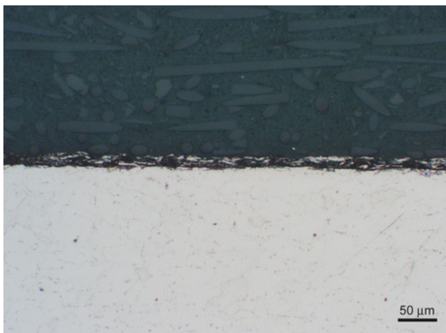
Obr. 4.5.2.4-7 Metalografický záznam korozního napadení povrchu po urychlené zkoušce (30 dní)
