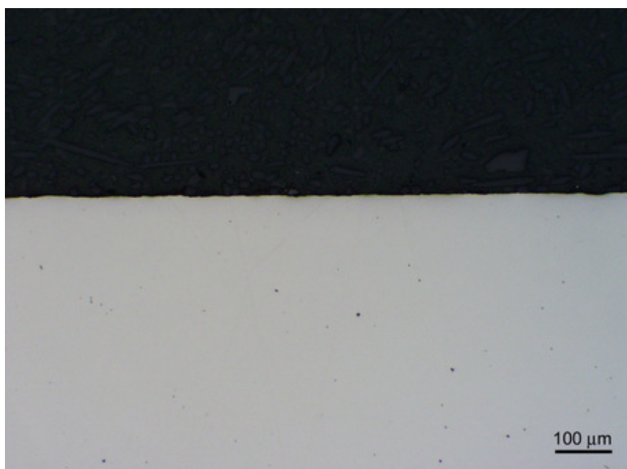
Obr. 4.5.2.4-9 Metallografický záznam korozního napadení povrchu po atmosférické zkoušce (30 dní)
