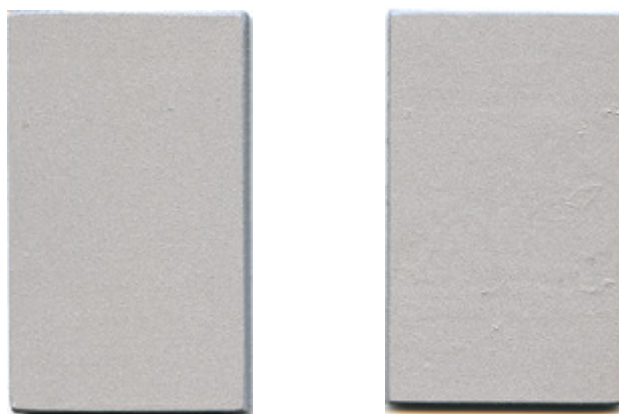
Obr. 4.2.2.4-1 Hliníkový a ocelový vzorek pasivovaný v Pragokor BP, utěsněný v Pragokor Seal Al a na závěr opatřený zinkovým povlakem
