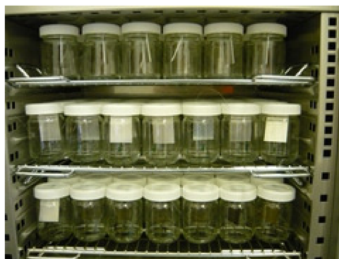
Obr. 4.4.1-4 Zkušební vzorky v první fázi zkušebního cyklu (8 hodin při teplotě 35°C a relativní vlhkosti 100%)
