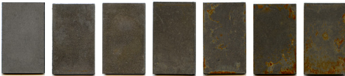
Obr. 4.5.2.2-12 Změna vzhledu povrchu ocelových zkušebních vzorků (pasivovaných v Pragokor BP a utěsněných v Pragokor Seal Al) v průběhu atmosférické zkoušky (0, 1, 2, 5, 13, 20 a 30 dní)
