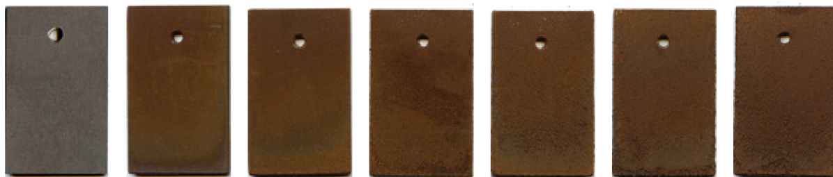
Obr. 4.5.2.2-1 Změna vzhledu povrchu ocelových vzorků (pasivovaných v přípravku Pragokor BP) v průběhu laboratorní urychlené zkoušky (0, 1, 2, 5, 13, 20 a 30 dní)
