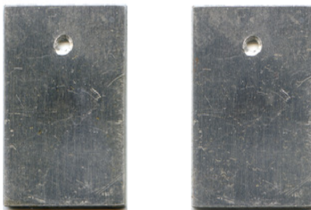
Obr. 4.5.1.2-7 Žádná změna vzhledu povrchu hliníkového zkušební vzorku (pasivovaného v přípravku Pragokor BP, utěsněného v přípravku Pragokor Seal Al a povlakovaného konzervačním voskem) před a po laboratorní urychlené zkoušce (30 dní)
