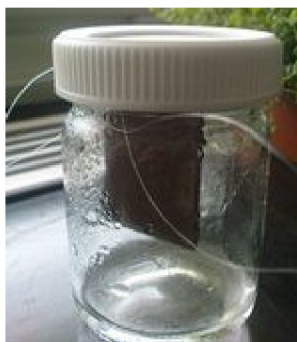
Obr. 4.4.1-2 Vzorek připravený pro urychlenou atmosférickou zkoušku
