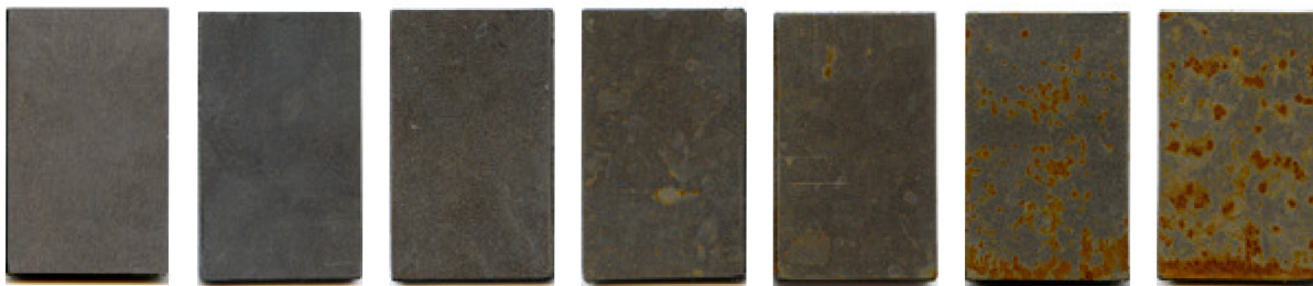
Obr. 4.5.2.2-10 Změna vzhledu povrchu ocelových zkušebních vzorků (pasivovaných v Pragokor BP) v průběhu atmosférické zkoušky (0, 1, 2, 5, 13, 20 a 30 dní)
