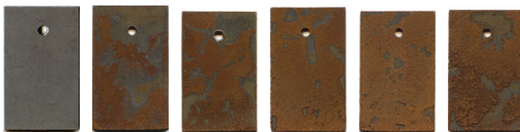
Obr. 4.5.2.2-3 Změna vzhledu povrchu ocelových vzorků (pasivovaných a utěsněných) v průběhu laboratorní urychlené zkoušky (0, 1, 2, 5, 13 a 20 dní)
