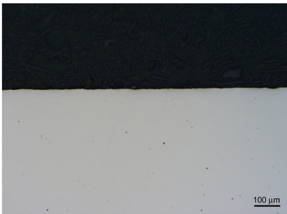
Obr. 4.5.2.4-9 Metalografický záznam korozního napadení povrchu po atmosférické zkoušce (30 dní)
