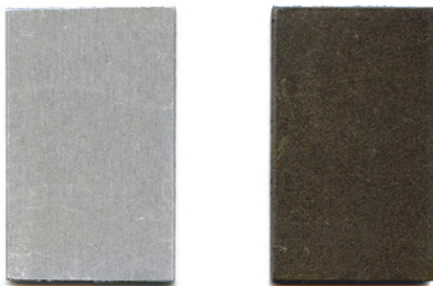
Obr. 4.2.2.3-1 Hliníkový a ocelový vzorek pasivovaný v Pragokor BP, utěsněný v Pragokor Seal Al a na konec opatřený povlakem konzervačního vosku WAXENG
