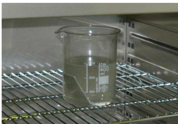
Obr. 4.2.2.1-1 Pasivace vzorku ponorem v lázni Pragokor BP při teplotě 60°C
