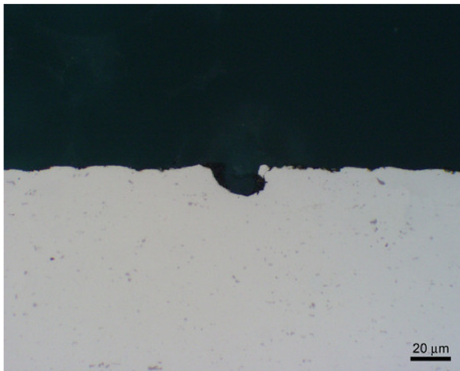
Obr. 4.5.1.4-3 Metalografický záznam korozního napadení povrchu po zkoušce (30 dní) (důlková koroze povrchu; tzn. přibližně stejná hloubka a šířka korozních důlků)
