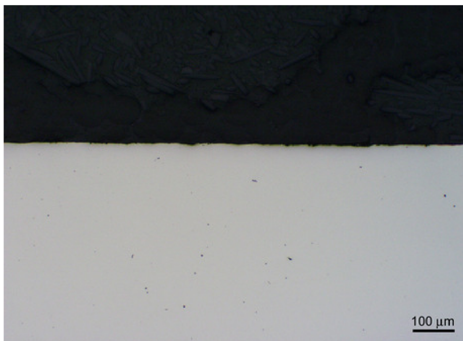
Obr. 4.5.2.4-3 Metalografický záznam korozního napadení povrchu po atmosférické korozní zkoušce (30 dní)
