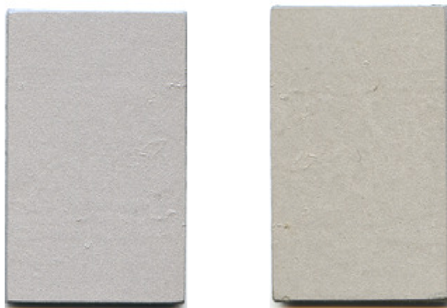
Obr. 4.5.2.2-16 Žádná změna vzhledu povrchu ocelového zkušební vzorku (pasivovaného v přípravku Pragokor BP , utěsněného v přípravku Pragokor Seal Al a opatřeného zinkovým povlakem) před a po atmosférické zkoušce (30 dní)
