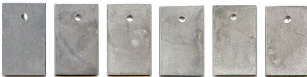
Obr. 4.5.1.2-4 Změna vzhledu povrchu hliníkových vzorků (pasivovaných v Pragokor BP a utěsněných v Pragokor Seal Al) v průběhu urychlené korozní zkoušky (0, 1, 2, 5, 13, 20 a 30 dní)
