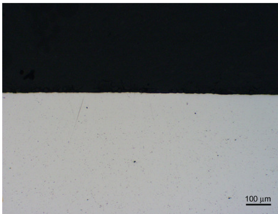
Obr. 4.5.1.4-5 Metalografický záznam korozního napadení povrchu po zkoušce (30 dní)
