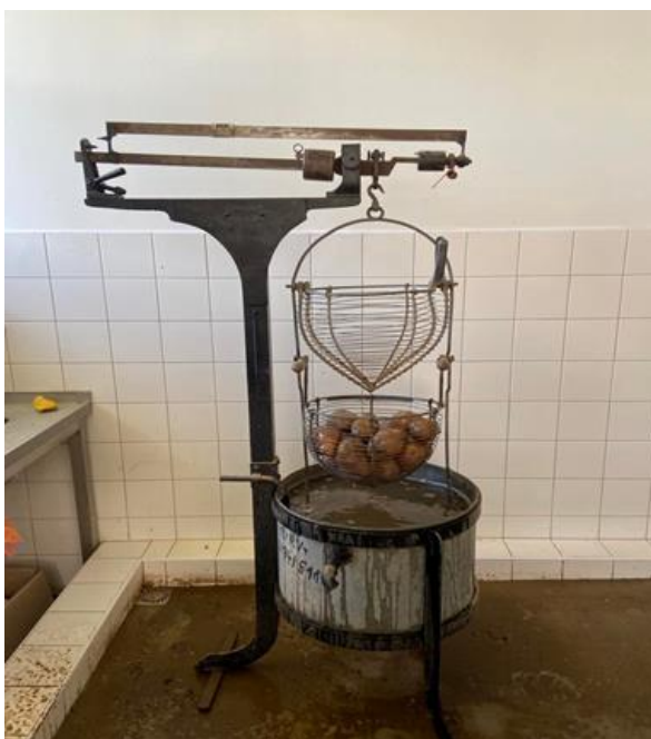
Obrázek 3: Ukázka stanovení obsahu škrobu v hlízách bramboru pomocí Hošpes-Pecoldovy váhy
