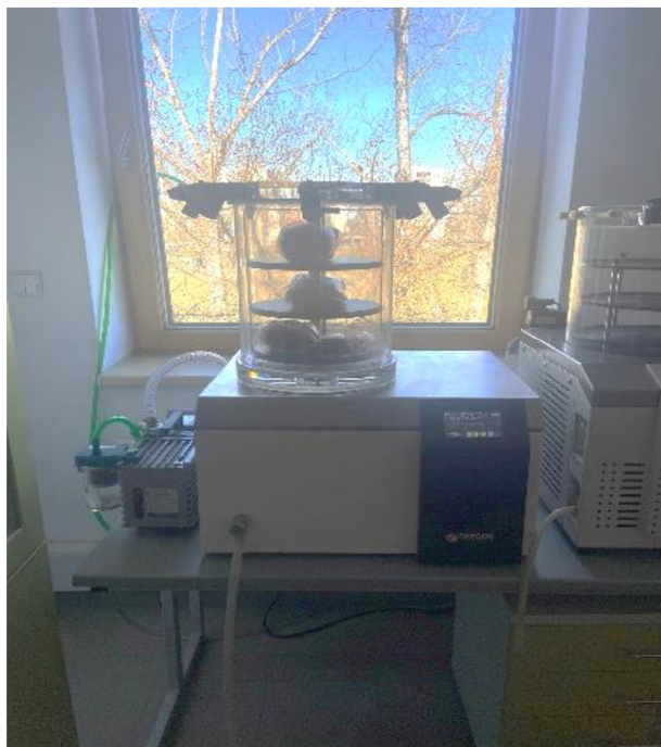
Obrázek 4: Ukázka stanovení obsahu sušiny v hlízách bramboru pomocí mrazového vysušení
