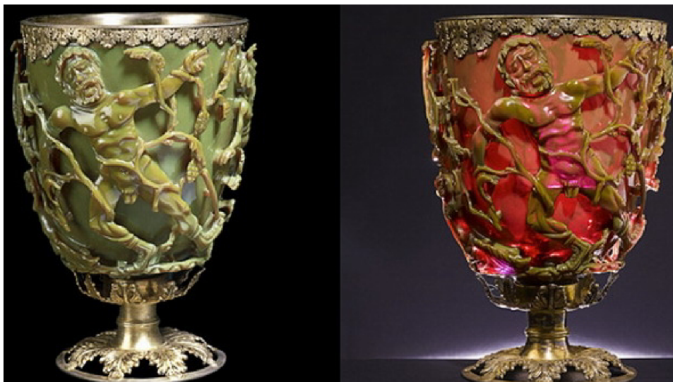
Obrázek 4.1: Kalich starý 1600 let umístěný v Britském muzeu vykazuje rozdílné zbarvení v odraženém denním světle (vpravo, zelené zbarvení) a proslém světle (vlevo, červené zbarvení). Obrázek převzat z [4].
