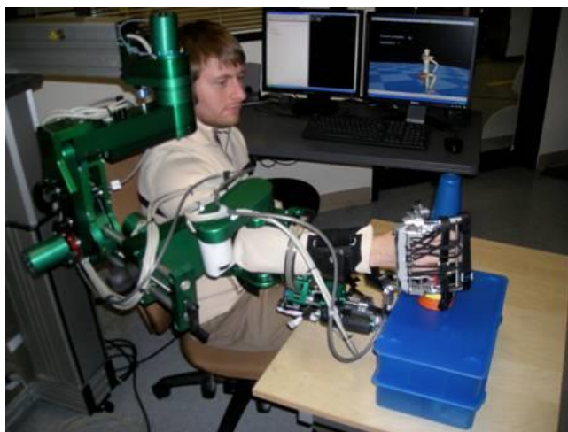
Obrázek č. 7. ARMin exoskeleton (Klamroth-Marganska et al., 2014, pp. 159-166)
