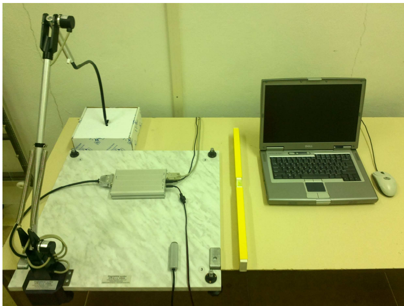
Obrázek 6. Polohový snímač upevněný na základní desce se třemi nastavovacími body a elektronická vyhodnocovací jednotka posílající údaje o poloze snímačů do počítače
