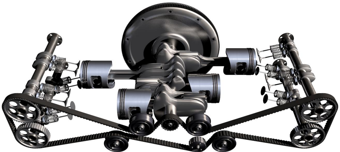
Obrázek č. 6 Čtyřválcový motor boxer s rozvodem DOHC
