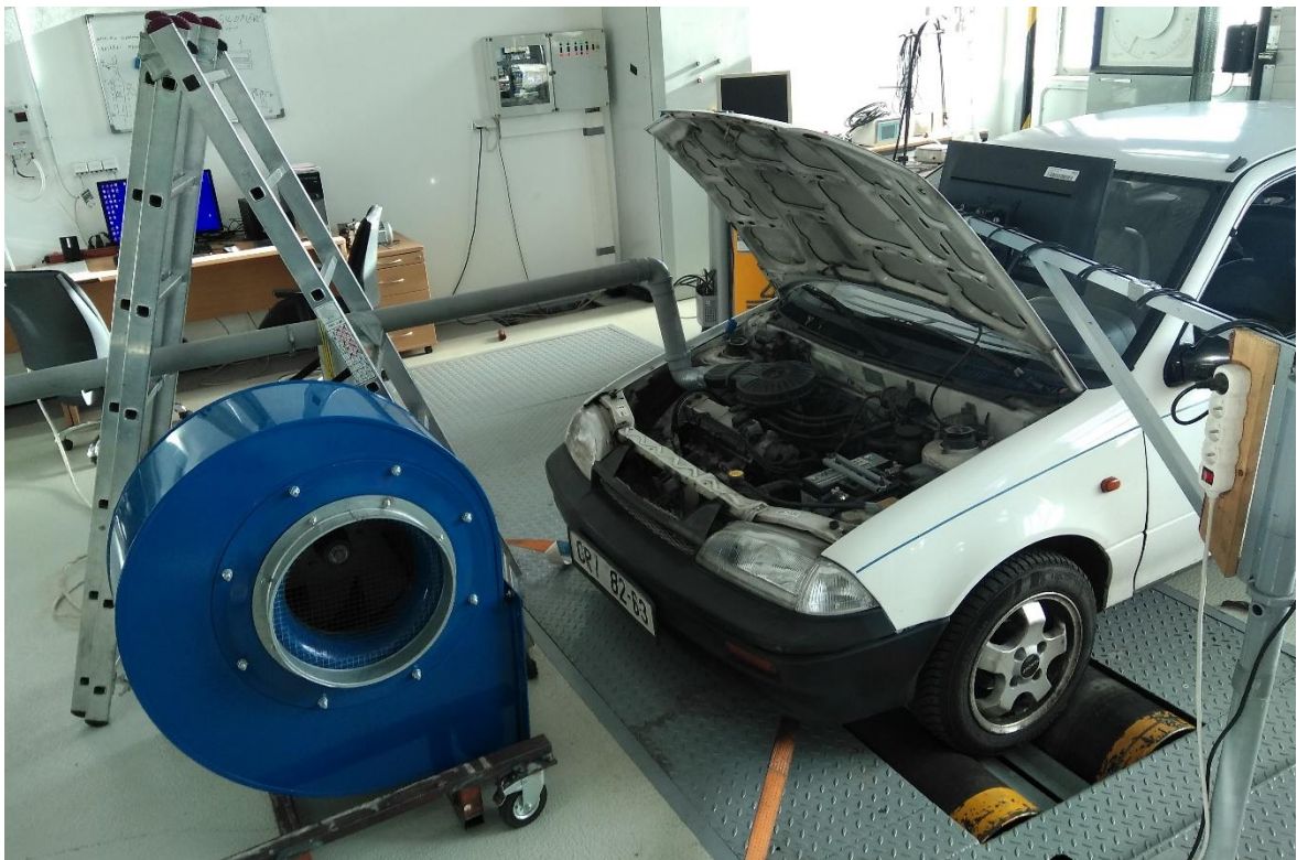
Obrázek č. 19 Automobil Suzuki Swift 1.0 při měření emisí na válcové zkušebně
