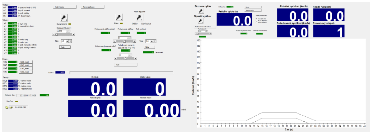
Obrázek č. 24 Programové prostředí Datalab pro řízení válcové zkušebny
