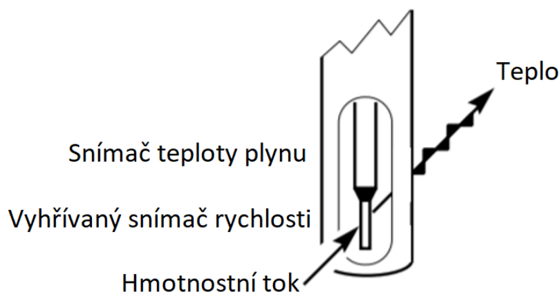
Obrázek č. 22 Senzor snímače hmotnostního průtoku vzduchu Sierra Fast-Flo 620S
