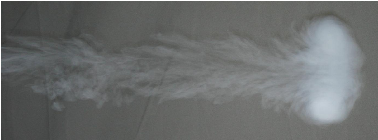
Obrázek 4.1: Fotografie letícího vírového prstence (vnitřní průměr použité fólie byl 160mm).
