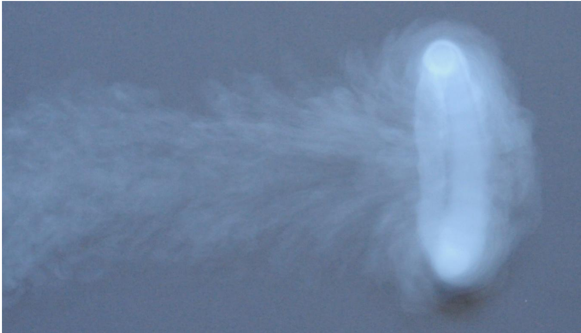
Obrázek 4.2: Fotografie s názornou ukázkou proudění kouře kolem vírové trubice (vnitřní průměr použité fólie byl 160mm).
