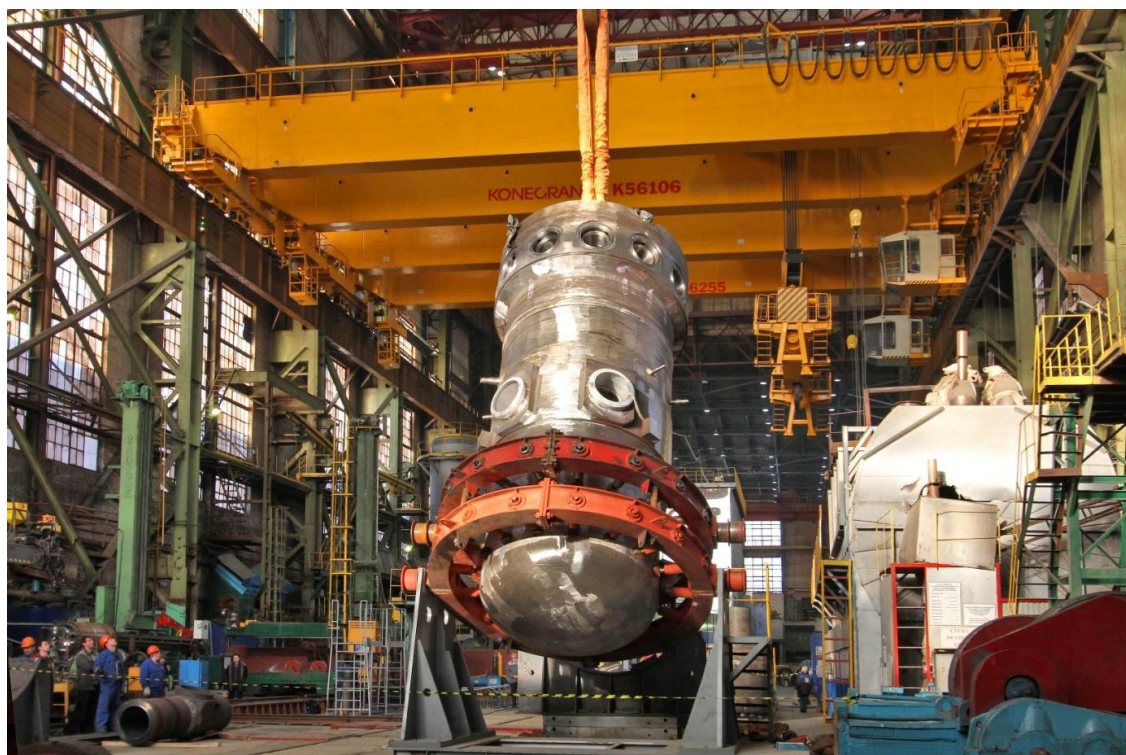
Obrázek 90: Tlaková nádoba reaktoru RITM-200
