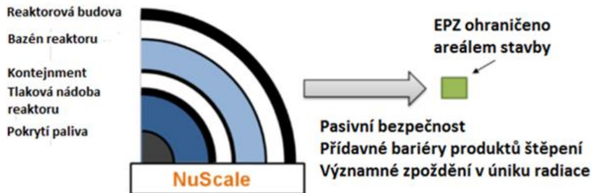
Obrázek 94: Ochrana do hloubky reaktorového systému NuScale
