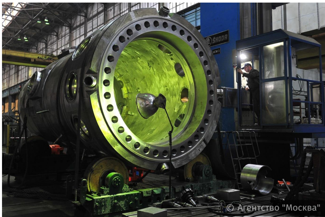
Obrázek 91: Tlaková nádoba reaktoru RITM-200
