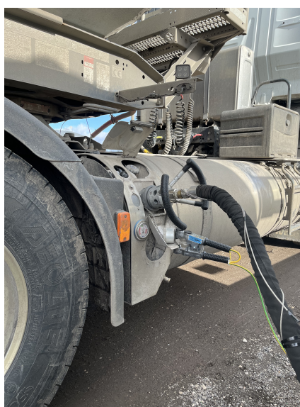
Obrázek 3.10: Plnění LNG do nádrží nákladního automobilu
