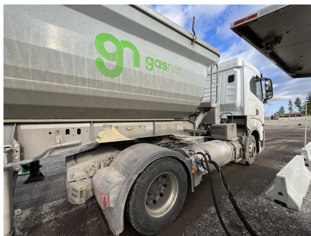
Obrázek 3.8: Upravení tlaku v nádržích před plněním
