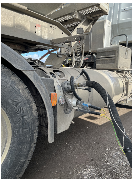
Obrázek 3.10: Plnění LNG do nádrží nákladního automobilu
