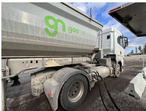
Obrázek 3.8: Upravení tlaku v nádržích před plněním
