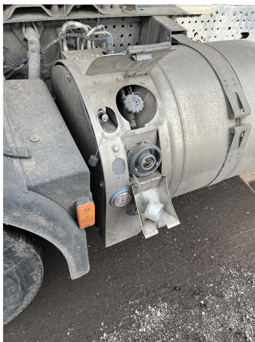
Obrázek 3.7: Palivová LNG nádrž
