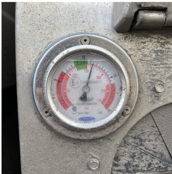
Obrázek 3.9: Ukazatel tlaku v nádržích
