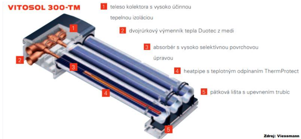
Obrázok 1. 7 – Rez trubicovým kolektorom typu heatpipe[8]
