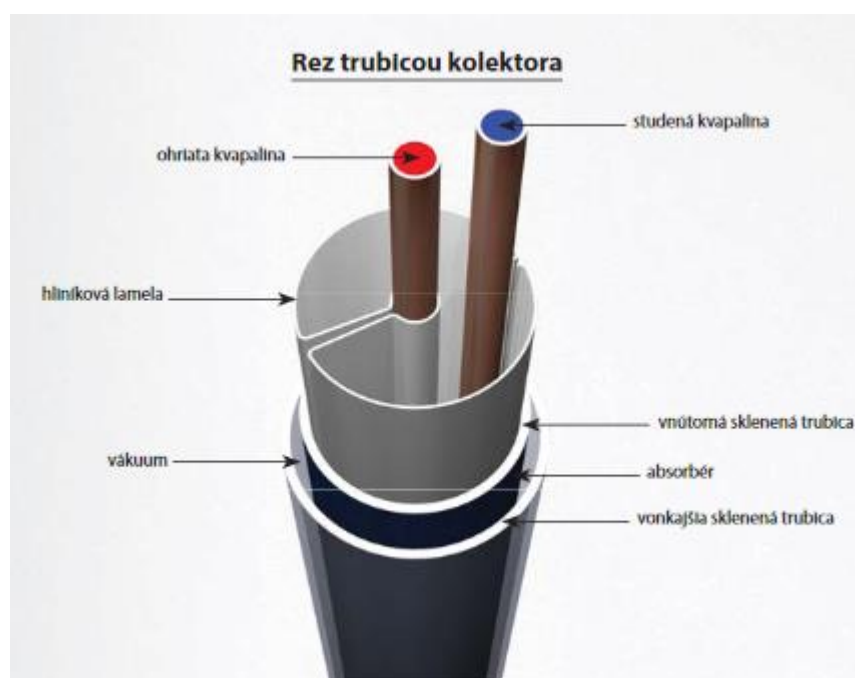
Obrázok 1. 12 – Rez priamo pretekaným trubicovým kolektorom [15]
