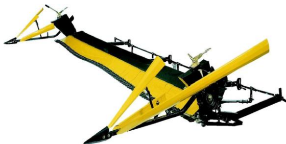
Obr. 25 : adaptér BISO FLEX SOJA na sklizeň sóji
