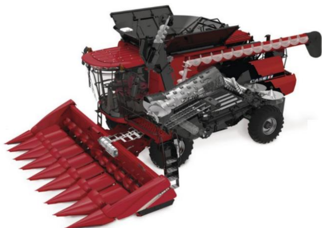
Obr. 29 : řez axiální mlátičkou CASE 7130
