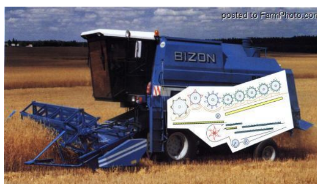
Obr. 33 : schéma mlátičky BIZON BS Z110
