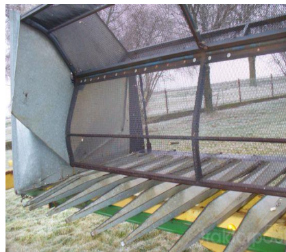
Obr. 24 : slunečnicový adaptér Poget na běžnou obilní lištu s upraveným přiháněčem
