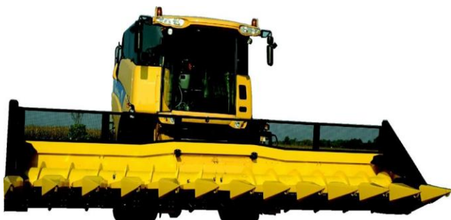
Obr. 23 : slunečnicový adaptér BISO SUNPOWER 12 řádků
