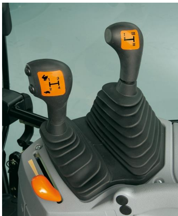
Obr. 2.11 Ovládání převodovky Dual Command 24/24 traktorů New Holland; páka hlavní čtyřstupňové převodovky, na které jsou tlačítka pro ovládání dvoustupňového násobiče točivého momentu a páka skupinové třístupňové převodovky [6]
