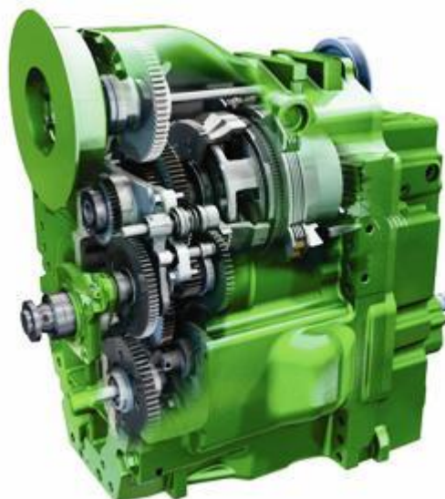
Obr. 2.15 Převodovka AutoPowr traktorů John Deere [5]
