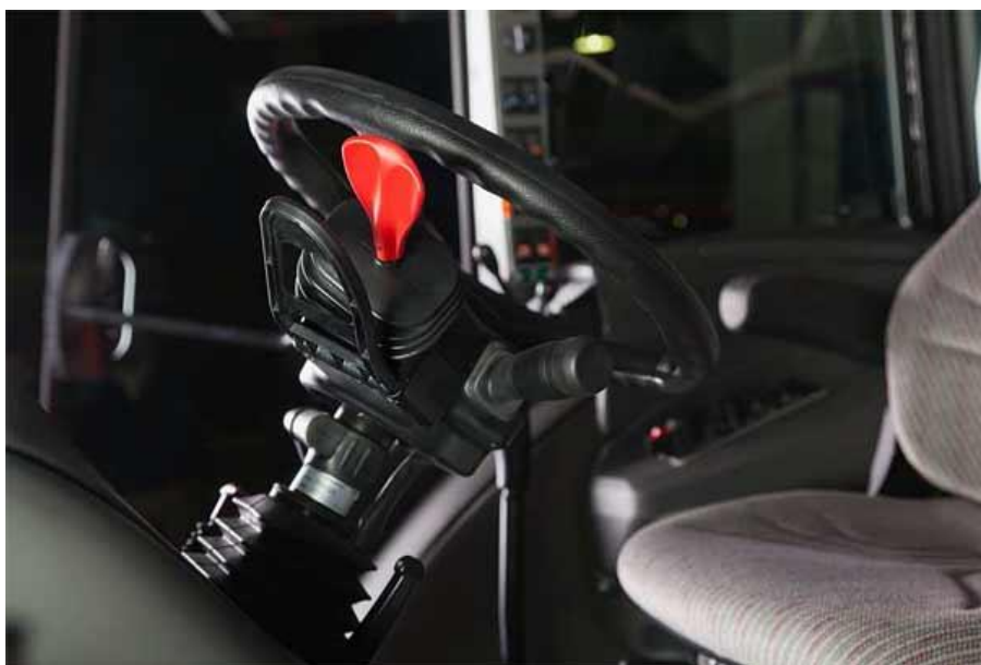
Obr. 2.10 Páka reverzace pod volantem (červená) [22]
