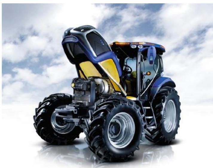
Obr. 2.2 Traktor na vodíkový pohon New Holland NH 2 [11]
