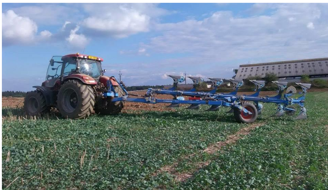
Obr. 3.1 Orební souprava - traktor CASE Puma 210 s pluhem LEMKEN Diamant 11
