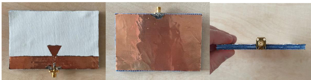
Obr. 3.1 Vyrobená anténní struktura: a) pohled shora, b) pohled ze zdola, c) pohled ze předu
