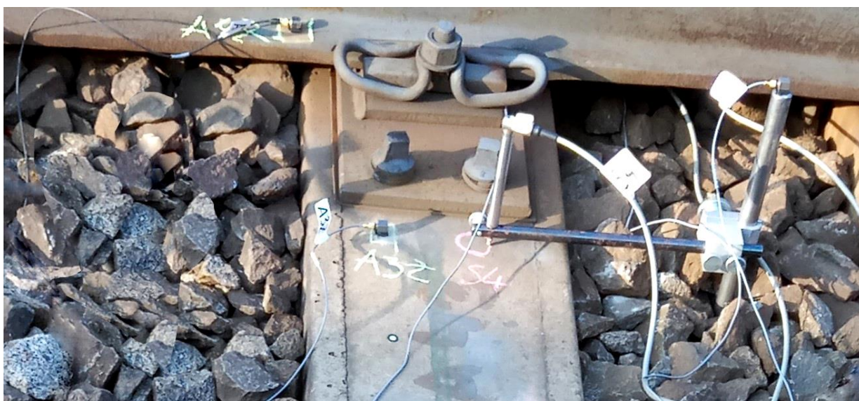
Obr. 5.2.2 Náhled umístění snímačů, zjednodušená metodika
