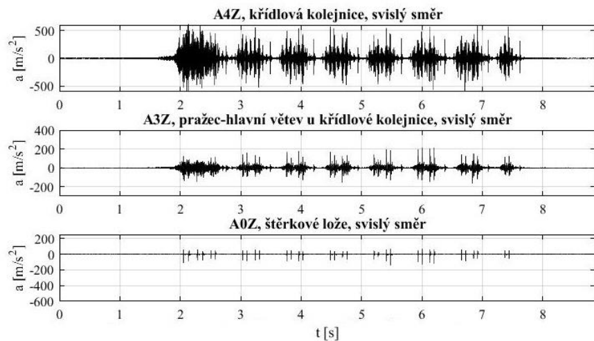
Obr. 6.2.5 Srovnání grafů zrychlení vibrací, výhybky č. 3 a 4 při průjezdu vlakových souprav 380 a RegioJet
